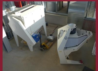
Bild 2: Bürstenmaschine und Steinausleser bei Rupp Landhandel GmbH, Foto: Thorsten Neubauer
